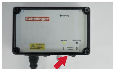
Kippschalter am Steuergerät in Stellung I „Betrieb“ bringen.
