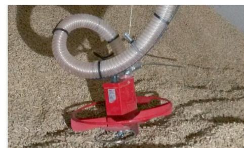
**Ziel:** Maulwurf sitzt auf den Pellets, Schlauch verläuft in leichtem Bogen zur Decke.
